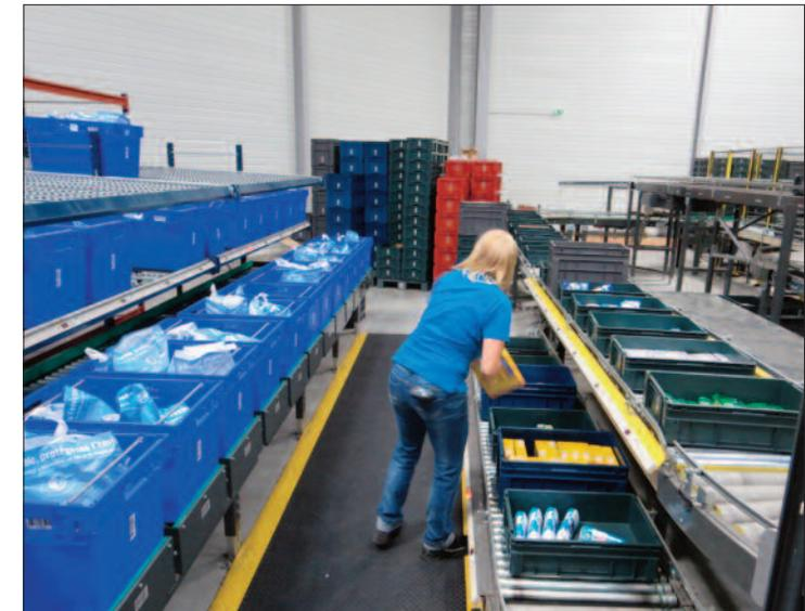
**La solution Alvey est organisée sur le principe du "transtockeur" : c'est cet automate (à gauche) qui rassemblent 11 000 bacs de stockage contenant les produits et les distribuent (photo du centre) selon les besoins des préparateurs dans la zone de picking (à droite).**
